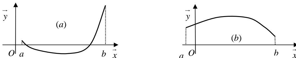
Figura 5.11 (a) grafico di una funzione convessa in (a, b) ; (b) grafico di una funzione concava in (a, b) .
