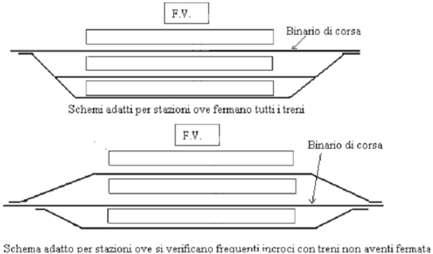
*Stazione per linea a singolo binario con tre binari di circolazione di cui il primo o il secondo sono di corsa*
