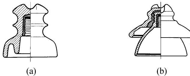
Fig. II.1 – Isolatori rigidi: a) per tensione fino a 1 kV; b) per tensione superiore a 1 kV.
